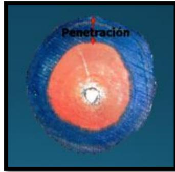
Figura 23. Penetración de preservante en madera de Melina.
