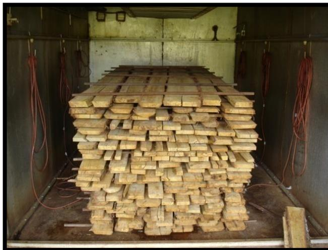
Figura 18. Secado convencional de madera.
