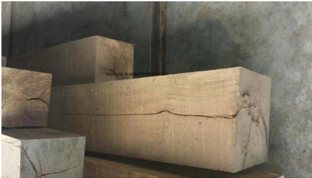
Figura 8. Pieza de almendro reventada
