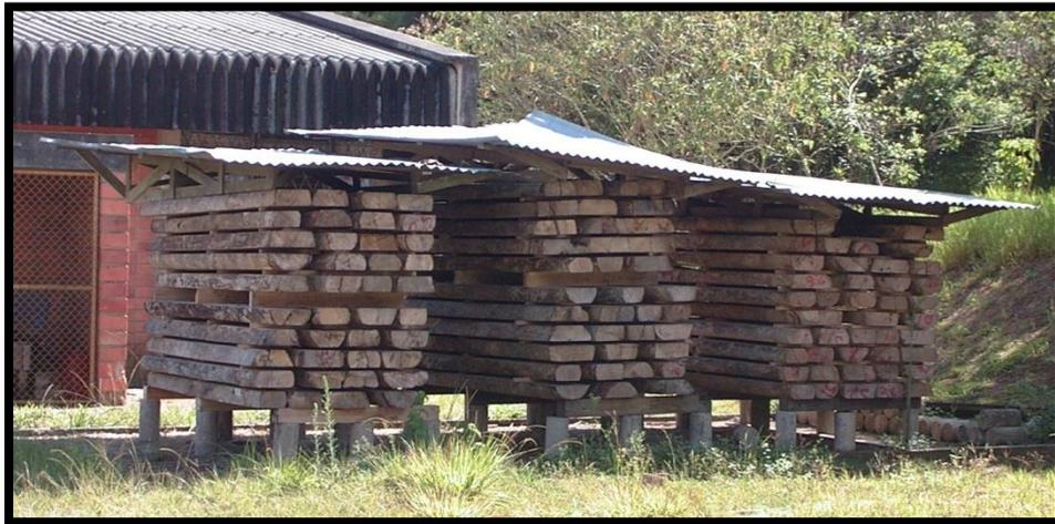
Figura 17. Pila de secado al aire.
