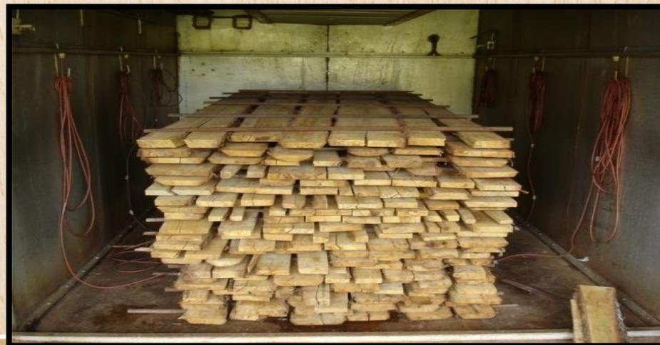
El programa de secado es la secuencia temperatura, humedad relativa y velocidad de circulación de aire a utilizar durante el secado artificial y generalmente son utilizados hornos convencionales. Se compone de las siguientes etapas:
