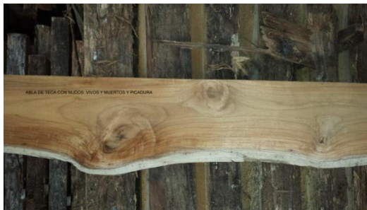
Figura 6: Tabla de teca con nudos vivos, muertos y picadura
