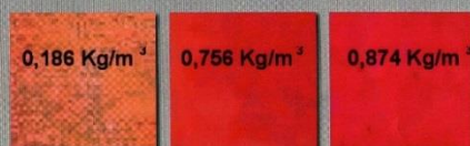
Figura 6. Retención según coloración en madera de melina con sustancia reveladora de boro
