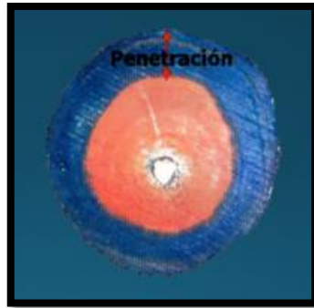
Figura 23. Penetración de preservante en madera de Melina.
