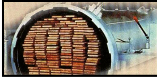
Figura 21. Tanque de acero donde se aplica el método de preservación vacío-presión. Foto: Róger Moya
