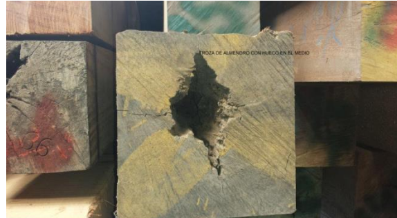
Figura 13. Troza de Almendro con hueco en el medio
