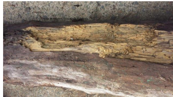
Figura 9. Trozas de Pochote con hueco por pudrición y troza totalmente podrida
