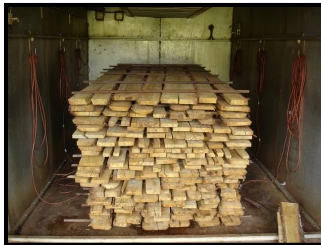
Figura 18. Secado convencional de madera. Foto: Roger Moya
