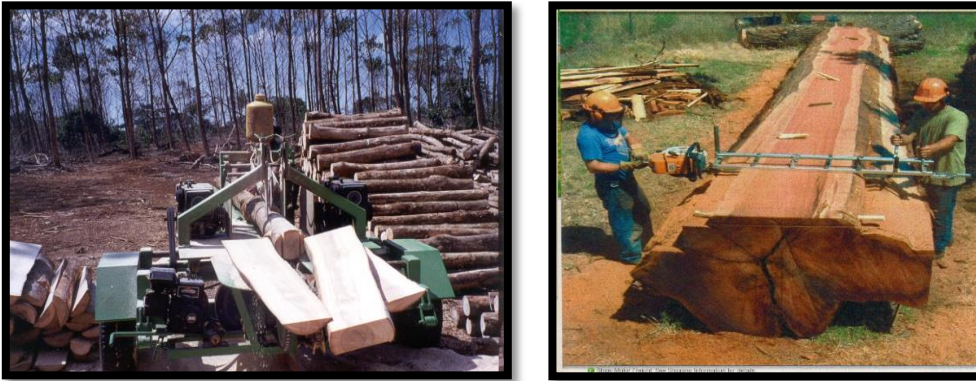
Figura 15. Aserradero móvil o portátil. Foto: Róger Moya
