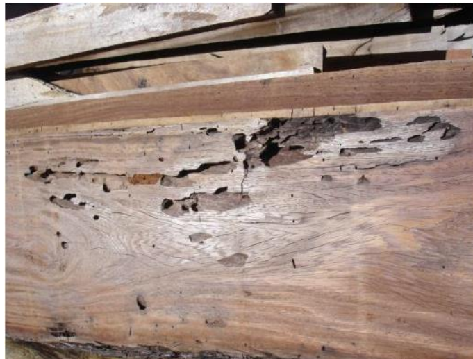
Figura 33. Agujero en la madera provocado por termitas
