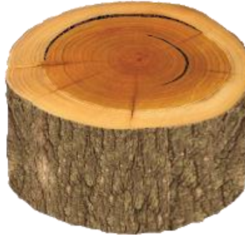
Figura 32. Vista transversal de acebolladura en madera en troza.
