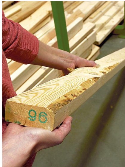
Figura 35. Arista faltante en una pieza de madera aserrada.
