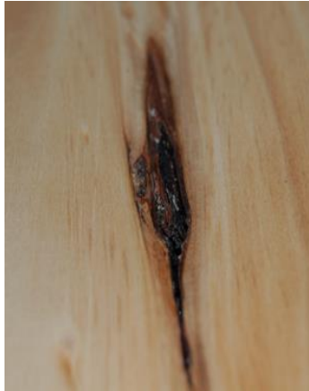
Figura 36. Bolsa de resina presente una pieza de madera de conífera
