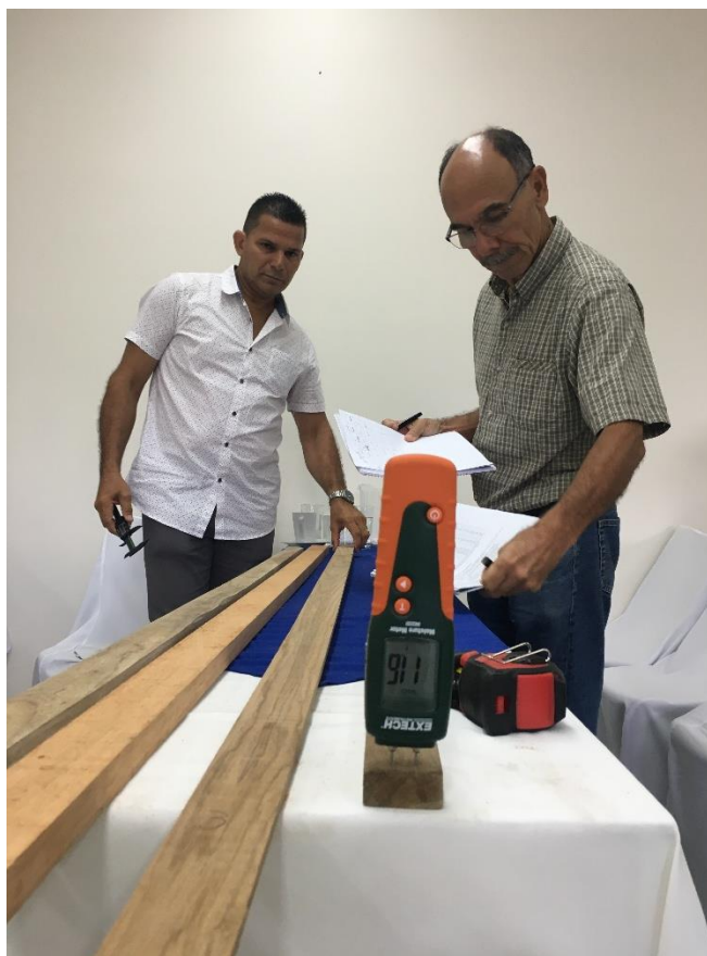
Figura 17. Los grupos clasificaron la madera según lo dicho por la norma INTE, para ello midieron el contenido de humedad utilizando el higrómetro.
