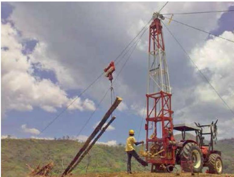
**Figura 10. Sistema de cable aéreo para extracción de teca en Pan American Woods, Costa Rica.**
